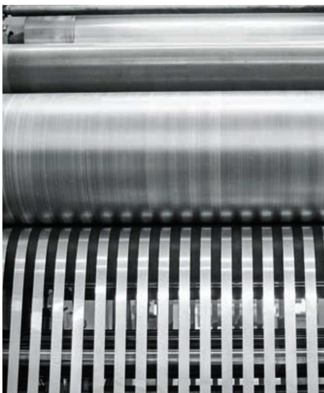
Skärmaskin i produktionsflödet och skurna aluminiumband för pläterad ranka.
